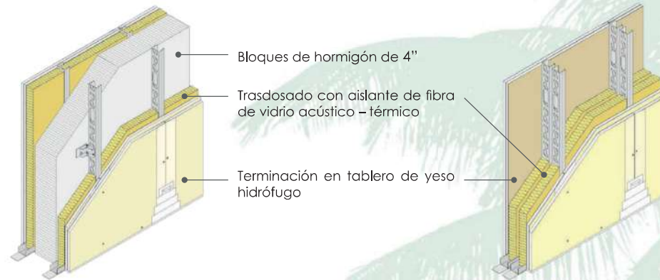
Tabique medianero entre apartamentos
